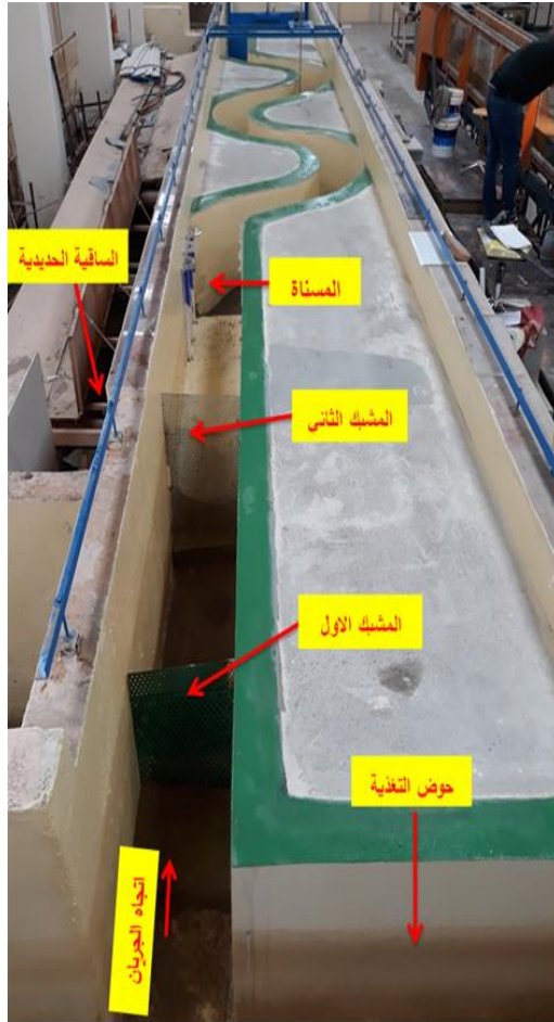
شكل رقم (1) يوضح القناة المختبرية المستخدمة في التجارب
