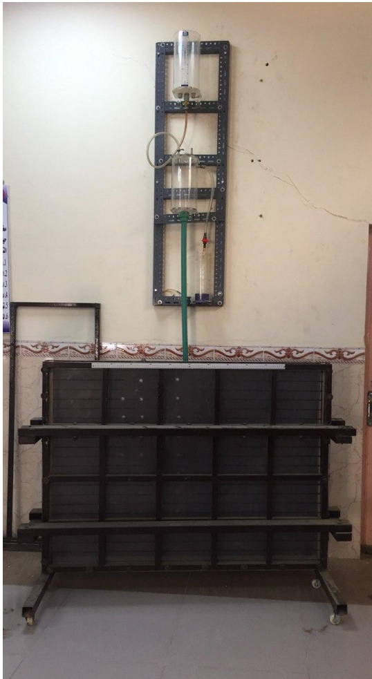
الشكل (1): يوضح حاوية التربة مع منظومة إضافة الماء
