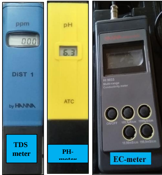
الشكل (8): الأجهزة المستخدمة في قياس بعض الخواص الكيميائية للتربة
