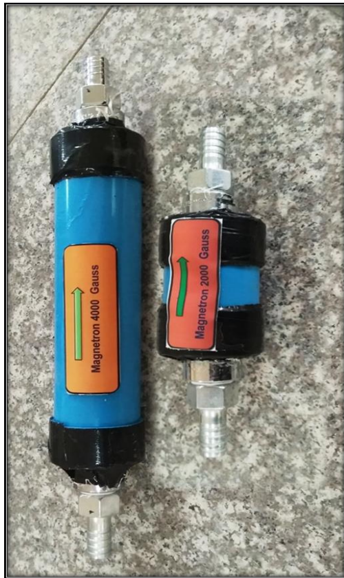
الشكل (3): أجهزة المغنطة بالشكل النهائي
