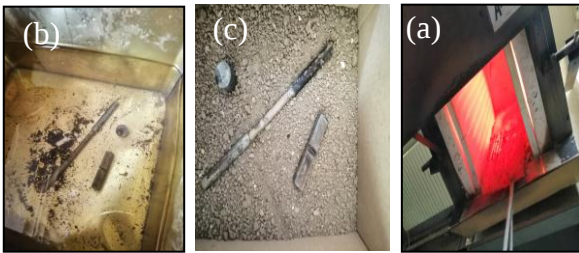
شكل (3): فرن المعالجة (a) والتبريد بالماء (b) وصندوق المعالجة بالتبريد بالرمال (c).
