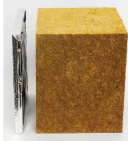
شكل (١٧): يتطلب الصوف المعدني سماكة من ثمانية إلى ١٠ أضعاف لتوفير قيمة العزل المكافئة للوحة العزل الفراغية (VIP).
