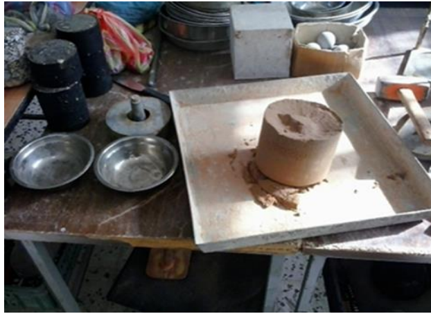
الشكل (10) فصل القالب واستخراج عينة التربة.
