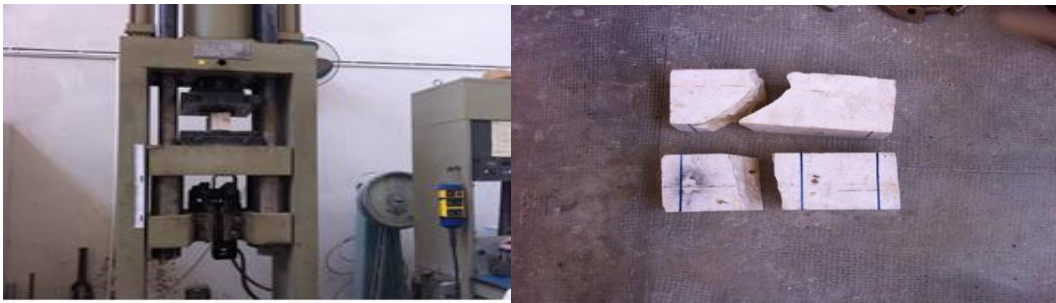
الشكل (7) عينة الحجر أثناء الاختبار على الشد
