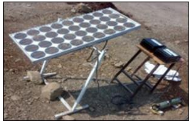
شكل ١٨: يوضح الألواح الكهروضوئية المستعملة وأدوات القياس للتجربة بمدينة بوبال بالهند [٣٧].
