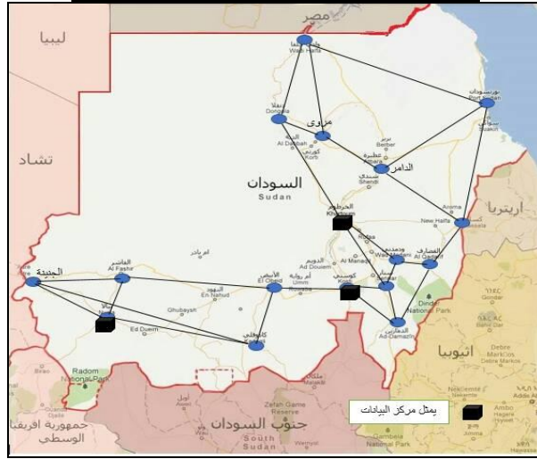
شكل (9) المواقع الأمثل لثلاثة مراكز بيانات في حالة طلب البيانات المعتمد على الكثافة السكانية
