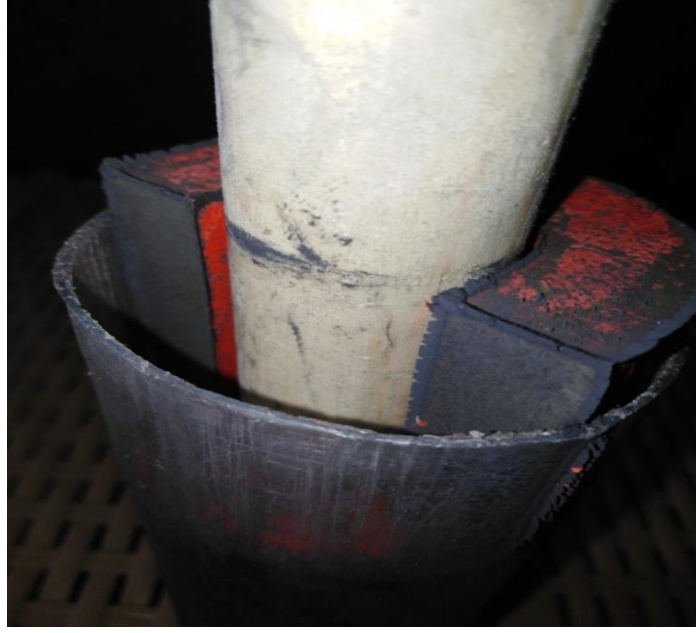
شكل (9): المغناطيس بعد التقاطه للماغنيتيت
