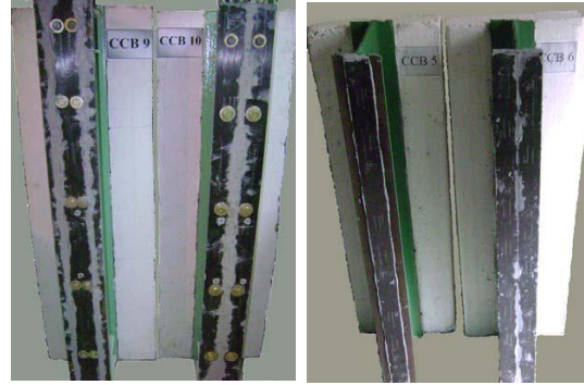
الشكل (6): تفاصيل الأبعاد والتغليف للعتبات [26].
