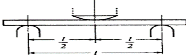
الشكل (7): اختبار تتي ثلاثي النقط [24].
