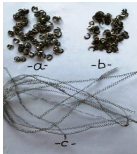
الشكل (5) أشكال الرايش الناتج عند الخراطة بوجود مجاري تكسير
