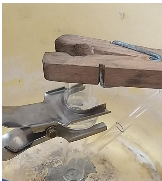
الشكل 2: خلية فرانز محلية الصنع
