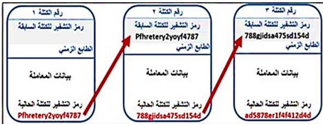
الشكل (2-4): توضيح آلية تشفير الكتلة باستخدام دالة الهاش داخل سلسلة الكتل
