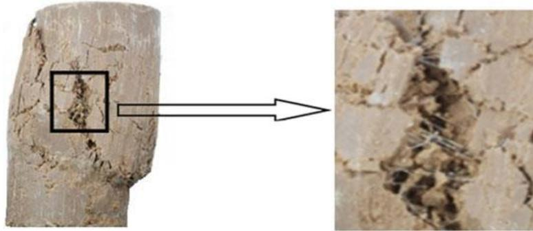
الشكل رقم (1) يوضح آلية عمل الألياف كجسور داخل هيكل التربة [4]
