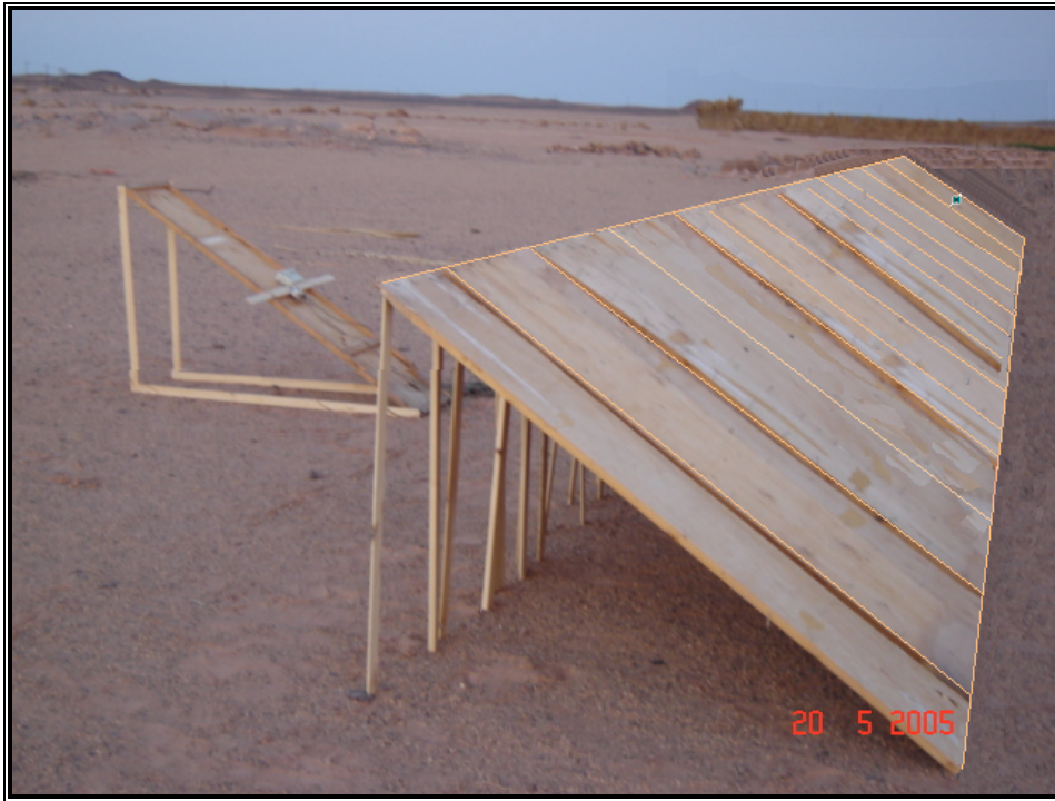
شكل (3-4) توزيع اللاقطات الشمسية في حقل شمسي نوع التوزيع خطي
