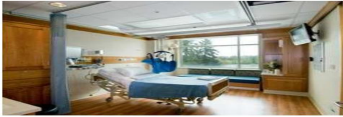
شكل (5-1) يوضح استخدام بلاطات السقف الماصة للصوت بمستشفى ميتويدت برونسون في كالامازو ميشغان ،
