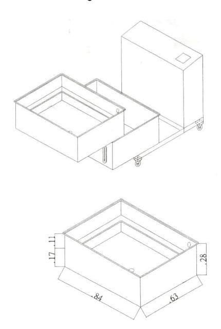
حوض سفلي مصنوع من نفس المادة وهو مستودع للماء بعد شفطه من الحوض عند عملية الترميم ويتسع لـ (140لتر) من الماء.
